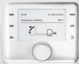
Regler für einfache bis komplexe Solaranlagen ohne Busverbindung zu einem Heizgerät
